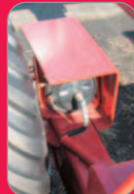
Den öppna konstruktionen håller drivrulle ren.
